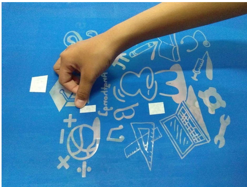
ภาพที่ 12 การอุดรูรั้วของบล็อกสกรีนด้วยกระดาษกาว
