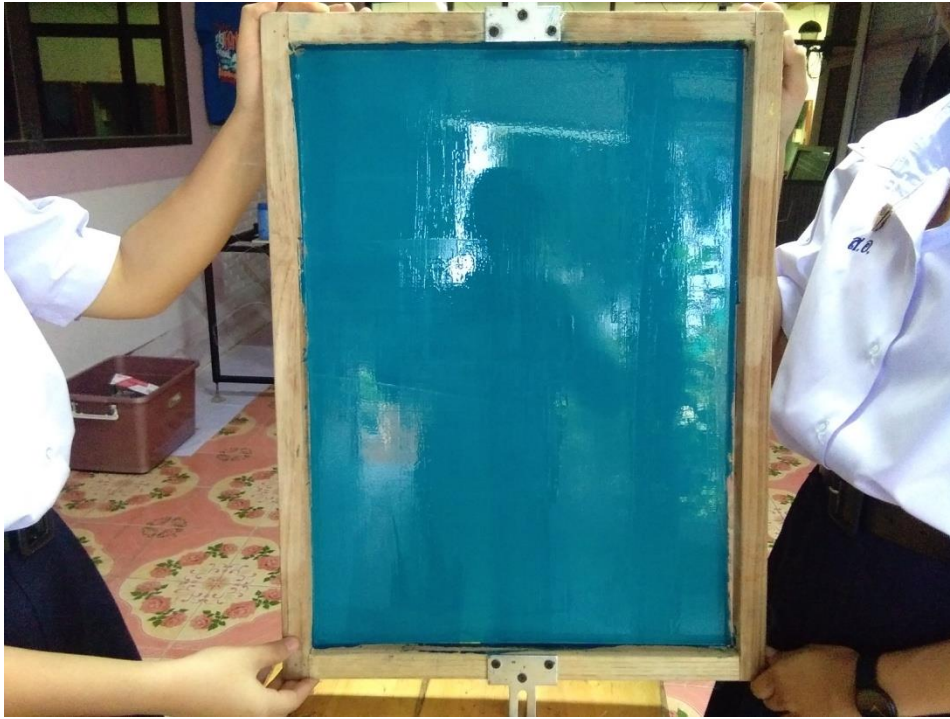
ภาพที่ 5 บล็อกสกรีนที่ผ่านการปาดกาวอัดเรียบร้อยแล้ว
